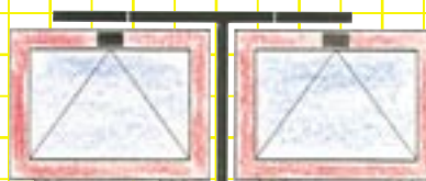
PRIMAT-FL 190 z narożnikiem teowym dla jednoczesnego uchylania 2-skrzydł jedno obok drugiego.
