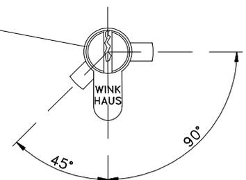
Einbaubereich des Profilzylinders ohne Umstellung des Schließbartes
